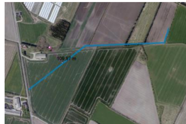
Figur 3-2 Ledningsføring fra biogasanlægget til transmissionsledningen.
